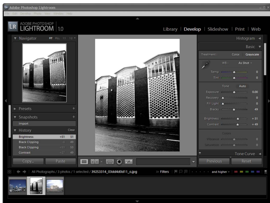
Рис. 24.2. Боковые панели в Adobe Lightroom заменяют десятки диалоговых окон. Этот подход похож на вариант с палитрами, представленный на рис. 24.1, но, в отличие от палитр, боковая панель не требует, чтобы пользователи располагали ее на экране, и не позволяет пользователю откреплять себя или закрывать (хотя можно скрыть всю боковую панель). Это еще больше сокращает интерфейсные наложения на управление объектами и представляет собой значительный шаг вперед относительно использования диалоговых окон для обеспечения доступа к функциям приложения
