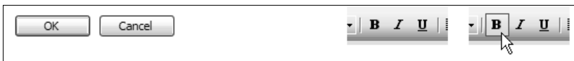
Рис. 19.3. Кнопки слева – пример статических визуальных подсказок. О возможности их нажатия сообщает объемная визуализация. Инструментальные кнопки-значки на панели справа – пример динамических визуальных подсказок. Переключатель полужирного текста на первый взгляд не кажется кнопкой, но наведение на него курсора мыши изменяет его внешний вид, отражая ожидаемое назначение
