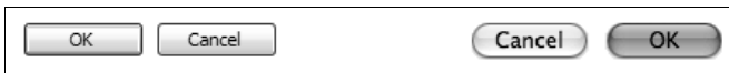
Рис. 21.1. Стандартные кнопки в Microsoft Windows (слева) и Mac OS X (справа). Применение теней и подсветки позволяет создать эффект объема, который наделяет кнопки свойством «нажимаемости»
